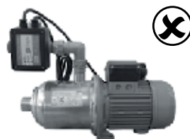
Λάθος τοποθέτηση του HiControl 1
