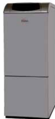
ATLAS D ECO K UNIT ΨΗΦΙΑΚΕΣ ΜΟΝΑΔΕΣ ΠΕΤΡΕΛΑΙΟΥ 30 και 42 kW Για θέρμανση και ΖΝΧ με boiler 100lt για 25kW και 130lt για 37kW. Με ενσωματωμένο καυστήρα, δοχείο διαστολής θέρμανσης, κυκλοφορητές inverter, βαλβίδα ασφαλείας, κ.τ.λ.
